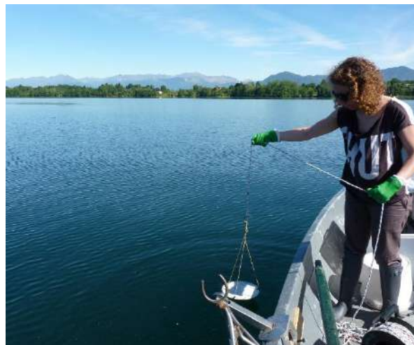
Figura 3-2. misura della trasparenza con disco di Secchi
