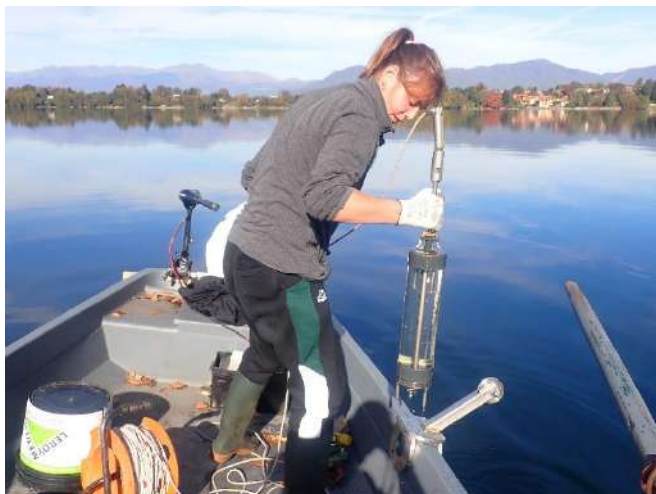
Figura 3-1. Prelievo campioni d'acqua con la bottiglia di Ruttner
